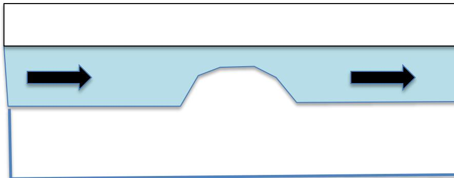
$$Q_{\text{cav}} \approx 5\text{-}10 \text{ l/h pour } \Delta P \approx 5\text{-}8 \text{ bars}$$
