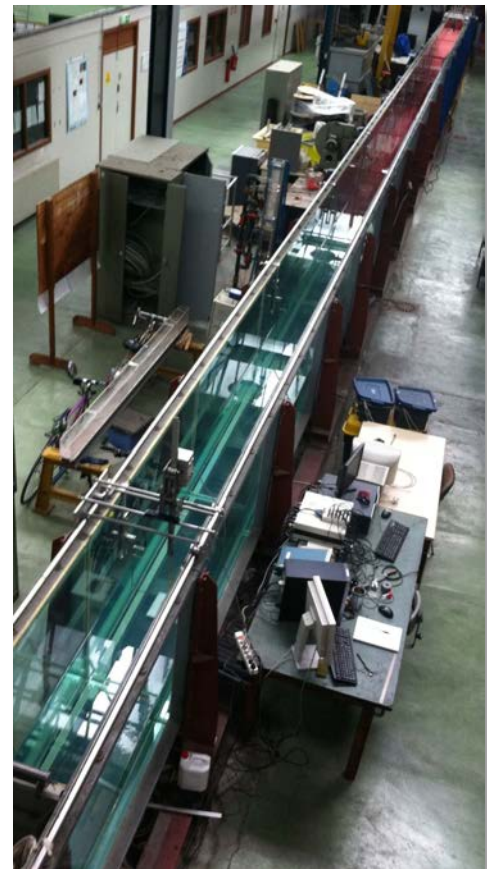
Canal à houle de 30 m du LEGI qui sera adapté au cours du projet WATU pour étudier la turbulence d'onde à 1D
