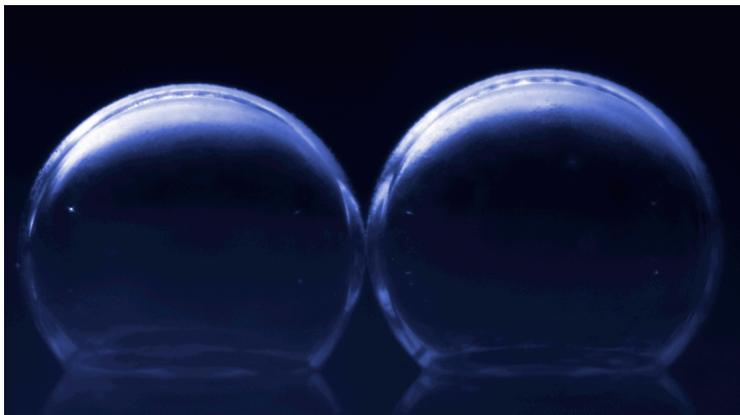
*Deux gouttes recouvertes de phospholipides sont mises en contact par électromouillage. Une bicouche lipidique se forme dans la zone de contact entre les deux gouttes.*
