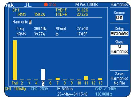
► *Mesures de la distorsion harmonique de conduction avec le logiciel TPS2PWR1.*
