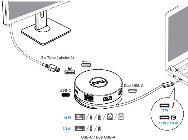
4. Le DA305 prend en charge une puissance de transmission allant jusqu'à 90 W lorsqu'il est connecté au port de foudre ou USB-C (Display Port Alt Mode) de votre PC. L'alimentation peut être fournie par l'adaptateur d'alimentation USB-C ou par l'écran USB-C avec une capacité d'alimentation qui prend en charge la fonction de charge. Les deux images suivantes montrent le DA305 connecté à une source d'alimentation externe via l'adaptateur d'alimentation USB-C ou le moniteur USB-C.
