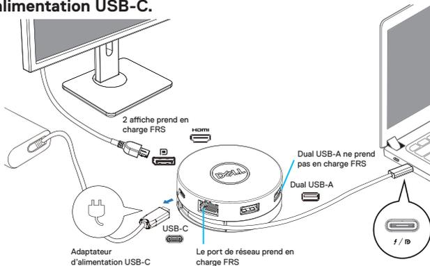
**Avec le passage de l'alimentation électrique via le moniteur USB-C.**
