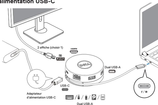
**Avec le passage de l'alimentation électrique via le moniteur USB-C.**
