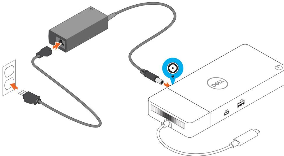
**Figure 6. Branchement de l'adaptateur CA**
