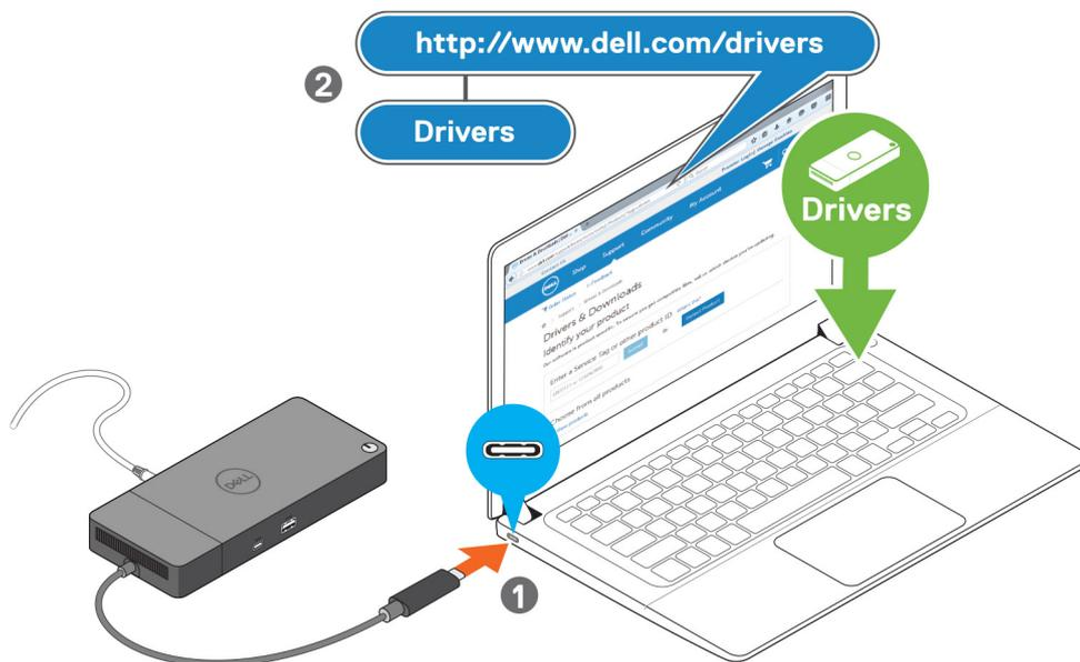
**Figure 7. Connexion du connecteur USB-C**
