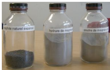
Au centre l'hydrogène de magnésium, la poudre produite par McPhy et compactée dans des disques de 30 cm de diamètre.
